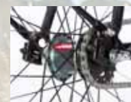
Automatische 2 versnellings naaf
