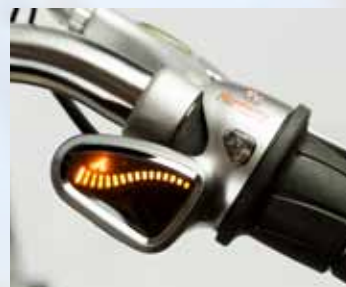
De Harmony optie is mogelijk op alle E-bikes met NuVinci naaf. Het maakt automatisch electrisch schakelen mogelijk. Je kan zelfs de rotatiesnelheid van de pedalen gelijk houden bij alle snelheden. (behalve stilstand) Meerprijs: €499,-
