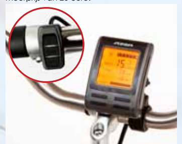
Deze LCD Display heeft een afstands-bediening: met dit knopje kunt u met een snelheid van 6km/u naast de fiets lopen, terwijl de motor de fiets voort duwt, vooral handig als je een heuveltje op wilt lopen. Ook kunt u met uw duim de ondersteuning regelen, terwijl u de handvatten niet los hoeft te laten. De kilometer teller laat zien hoe ver u nog kunt rijden met de accu. De display heeft 15 ondersteuningsstanden, u kunt hiermee uw snelheid precies aanpassen aan uw medefietsers. Meerprijs €125,-
