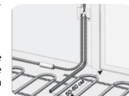
Voorbeeld van sensor in sleuven.
